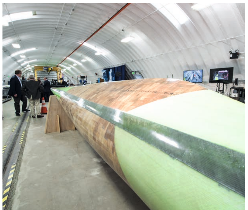
Windkraftflügel aus Holz könnten Windkraftanlagen nachhaltiger werden lassen. Foto: Dennis Schroeder, NREL
